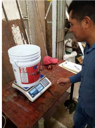
Figura 3-27 Aforo con cubeta de 19 litros.
