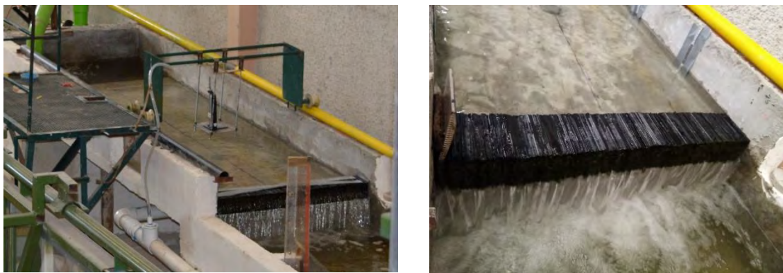
Figura 3-22 Uniformizador instalado aguas abajo en el modelo físico.
