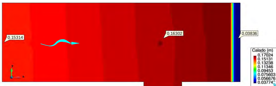
Figura 4-119 Comportamiento del tirante en la surgencia con descarga ahogada de la tapa de concreto.
